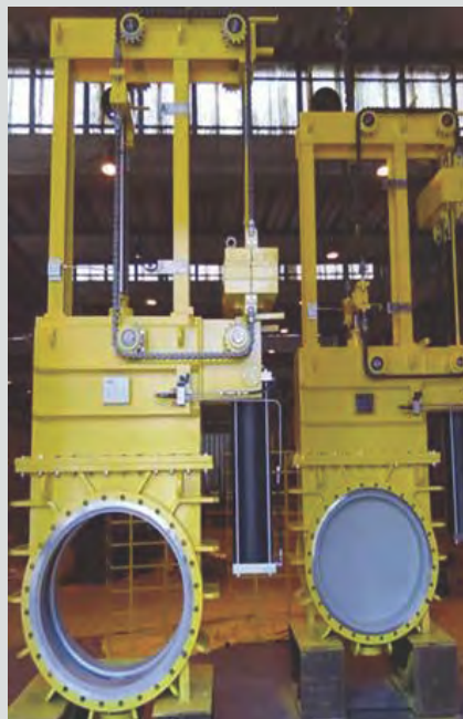
VÁLVULA GAVETA TIPO CUNHA EM CUNHA DOUBLE DISC GATE VALVE
