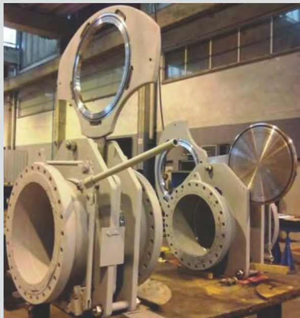
VÁLVULA OCULAR TIPO ROTATIVA – ALAVANCA GOGGLE VALVE, ROTARY AND MANUAL - LEVER
